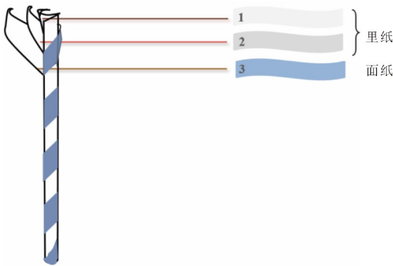
图 1 纸吸管结构图
