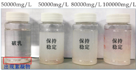
图 4 调驱剂的抗盐性能测试结果照片
