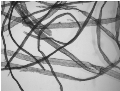
图 1 纸尿裤边角料绒毛浆纤维的显微镜图(×100)
