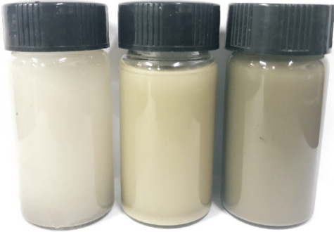
图 1 分形结构银微粒样品图(从左到右分别为一级结构、二级结构、三级结构分形结构银微粒)
