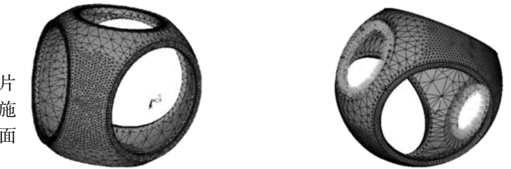
图 2 轮毂有限元模型 图 3 自由度约束
