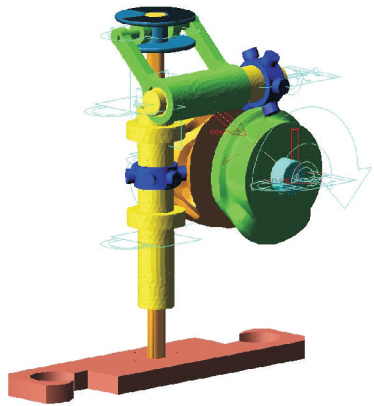
图 5 替换柔性体构件后的虚拟样机
