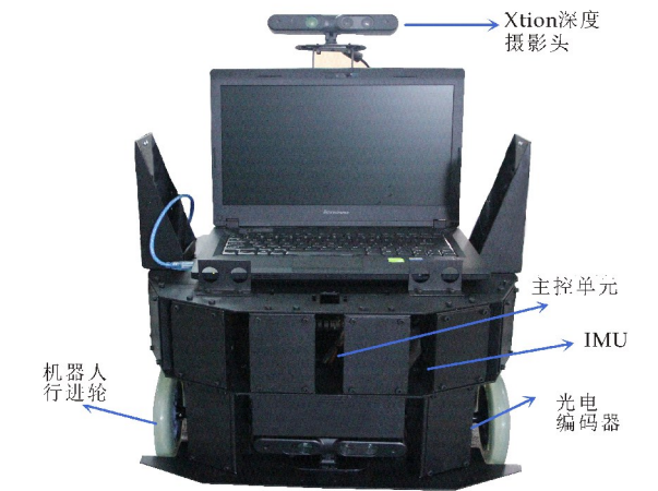
图 2 移动机器人导航系统平台实物图
