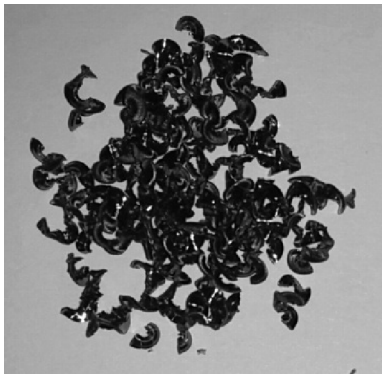
(c)速度 162 m/min 下产生的切屑
