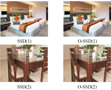
图 7 O-SSD 模型与 SSD 模型对小目标检测结果对比图
