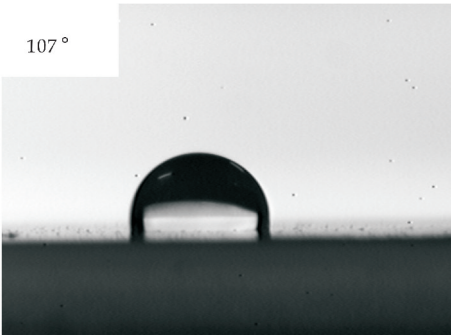
(b) 改性的 WPU 胶膜水接触角
