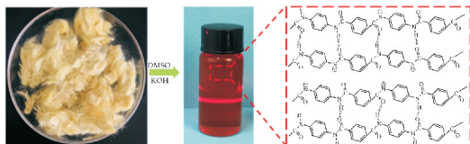
图 1 芳纶纳米纤维 (ANF) 的制备过程示意图
