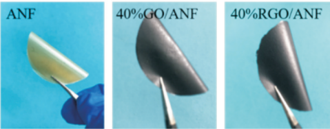
图 9 ANF、40% GO/ANF 和 40% RGO/ANF 薄膜的光学照片
