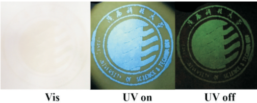
图 9 基于 BrNCDs 的防伪印刷照片
