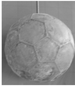
图 8 内压 0.45 MPa 成形实物照片 图 9 内压 0.45 MPa 成形实物局部照片
