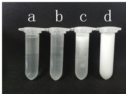
a: 乙酸乙酯; b: IPM; c: 液体石蜡; d: 二甲基硅油 图 1 不同油相形成纳米乳的外观
