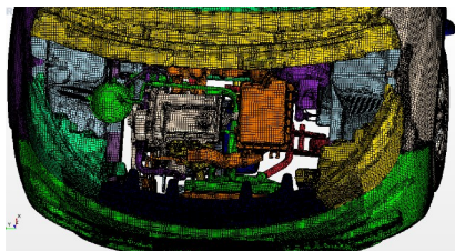
图 4 整车机舱网格示意图
