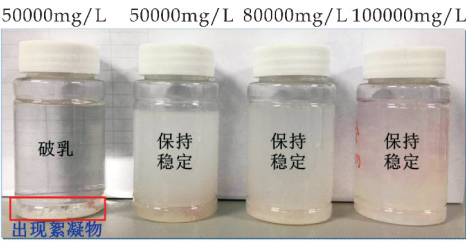
图 4 调驱剂的抗盐性能测试结果照片
